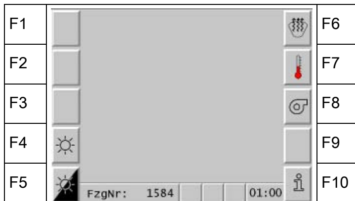
38 ábra: „A fűtő- és klímaberendezés” alapkijelzéssel
