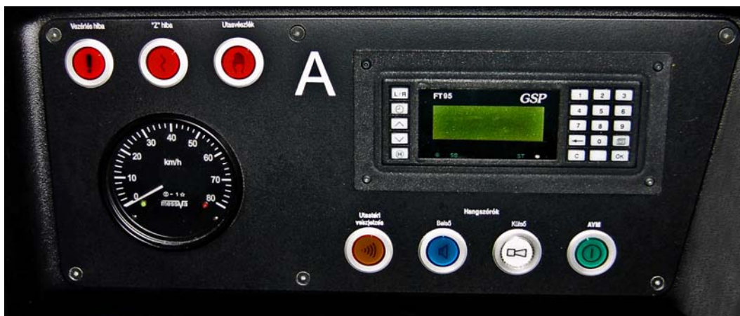
18. ábra: Menetadat kijelző és kommunikációs kezelőtábla az IBIS-kezelőkészülékkel
