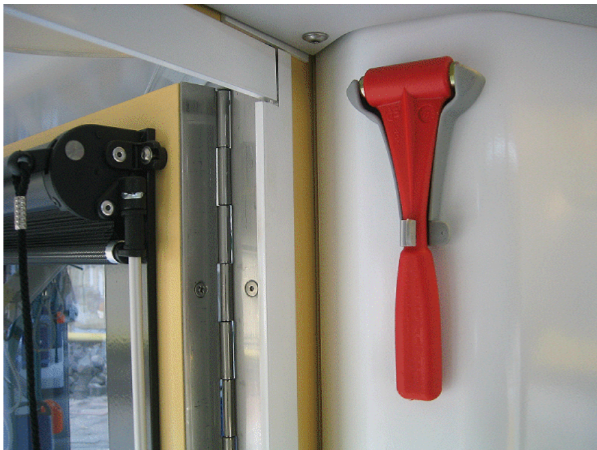
49 ábra: A vezetőállásban található ablaktörő kalapács
