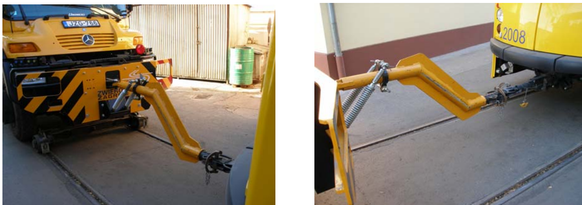
59 ábra: Csatolás Unimog tehergépkocsival
