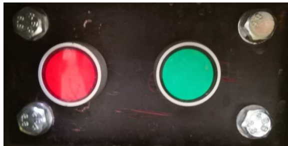
4. ábra: A jármű végein található külső ajtókezelő nyomógombjai
