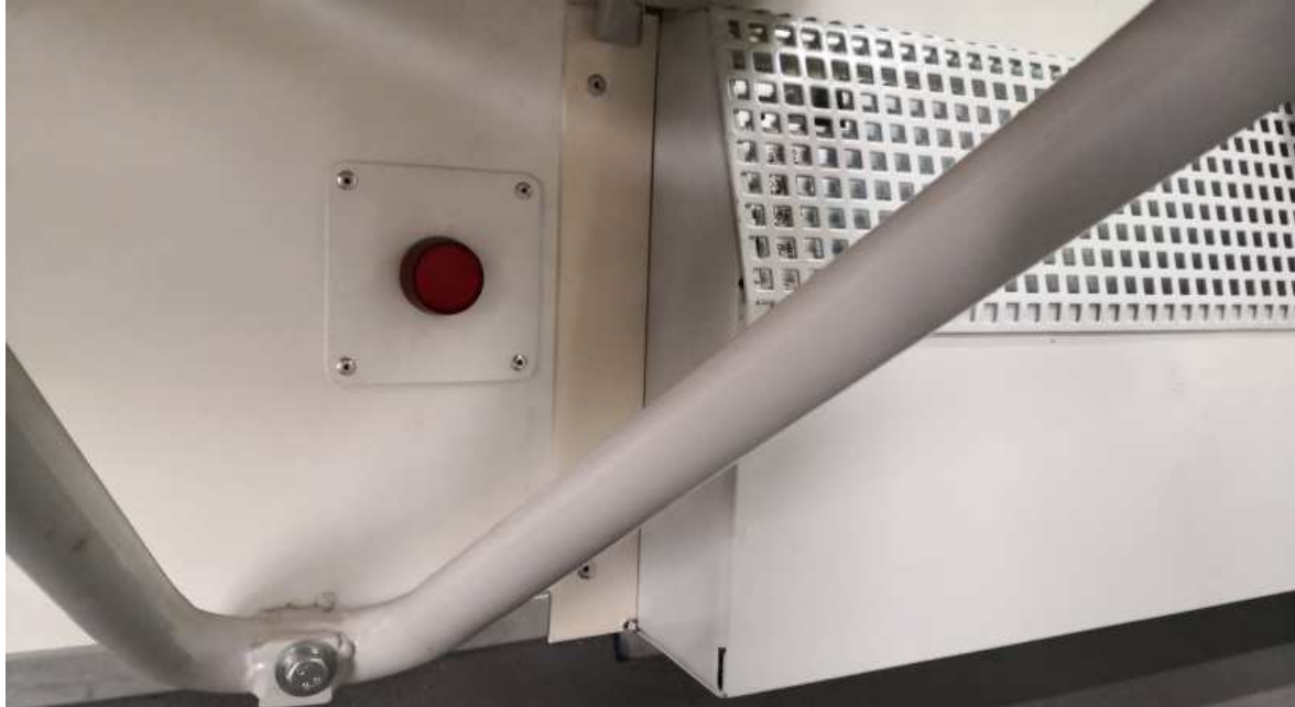
9. ábra: Utastéri fűtés visszajelzése az ülések alatt
