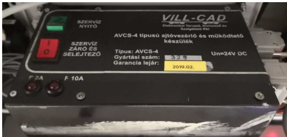
5. ábra: A jármű utastéri ajtóihoz tartozó vezérlődoboz
