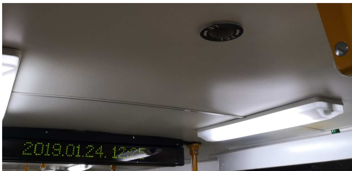
8. ábra: A hajtókar csatlakozó nyílása az utastérben a mennyezeten
