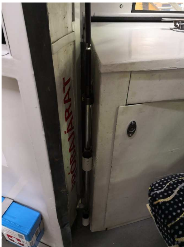
6. ábra: Az „A” fülkében elhelyezett áramszedő hajtókar
