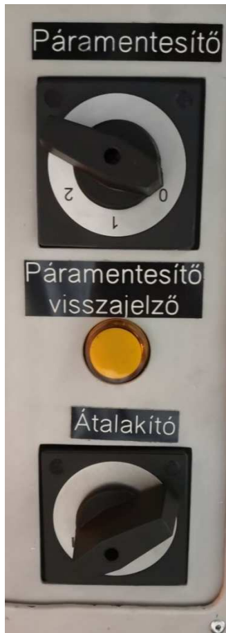
3. ábra: A 1441-es psz. villamos "A" fülkéjében található mennyezeti kapcsolók
