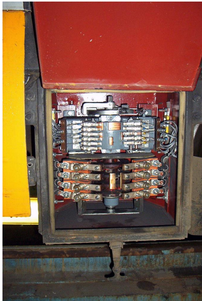
17. ábra. leselejtezett motorpár irányváltó hengere
