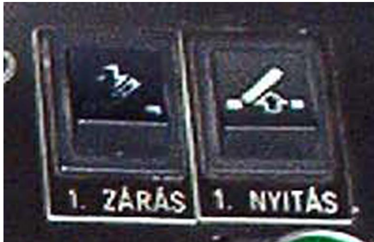
52. ábra. ajtóműködtető kapcsolók a műszerasztalon
