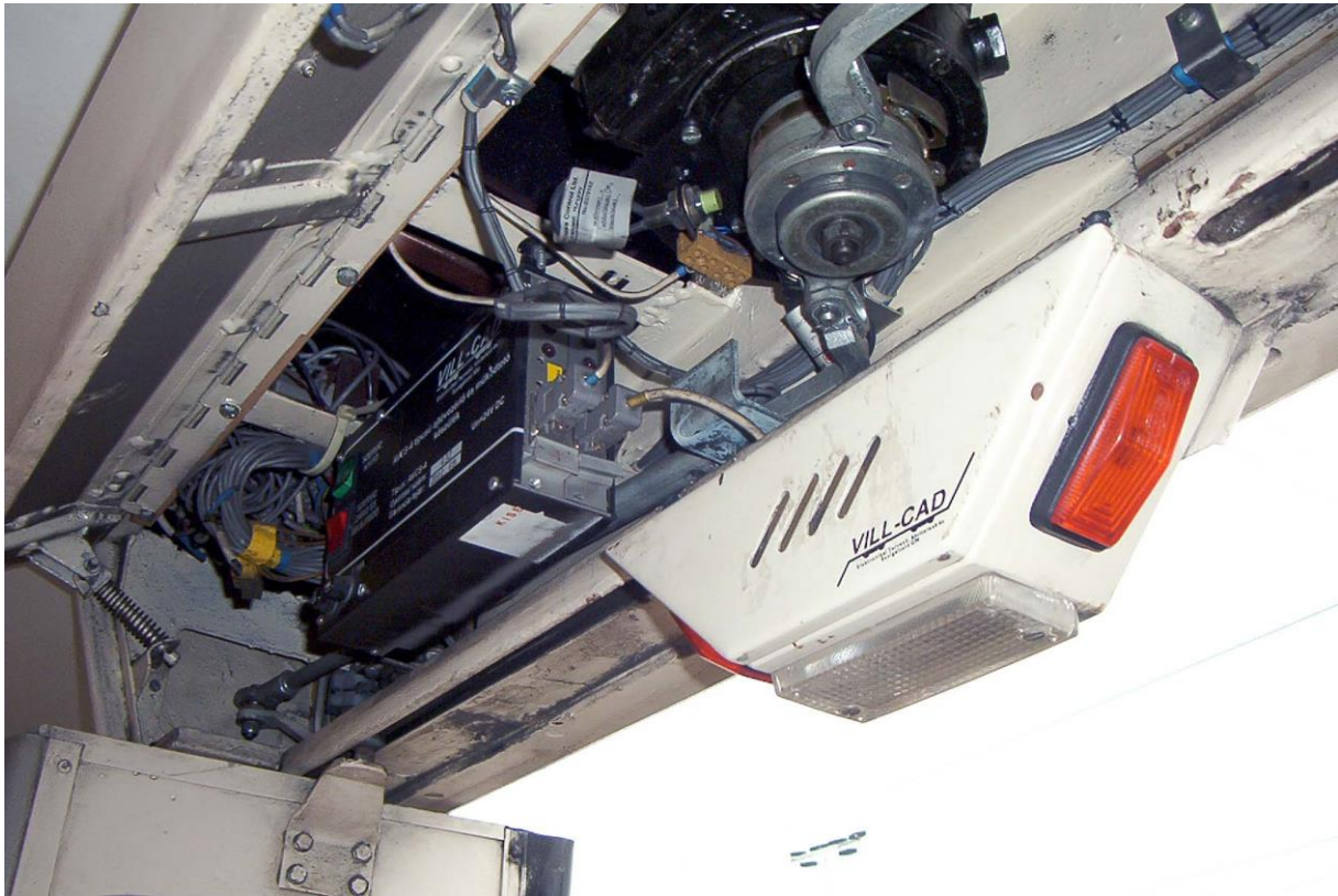
48. ábra. Elektronikus vezérlő egység az ajtó működtetéséhez
