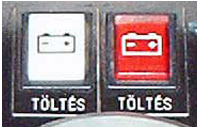
30. ábra. visszajelző lámpák a műszerasztalon
