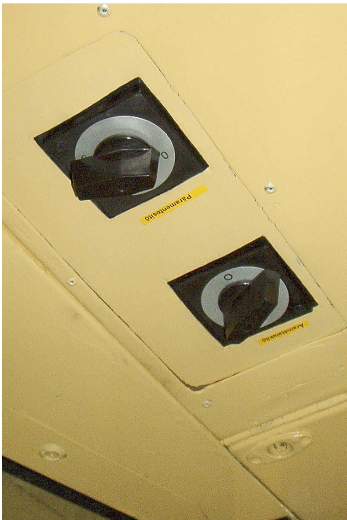
34. ábra. páramentesítő és a statikus átalakító kapcsolój
