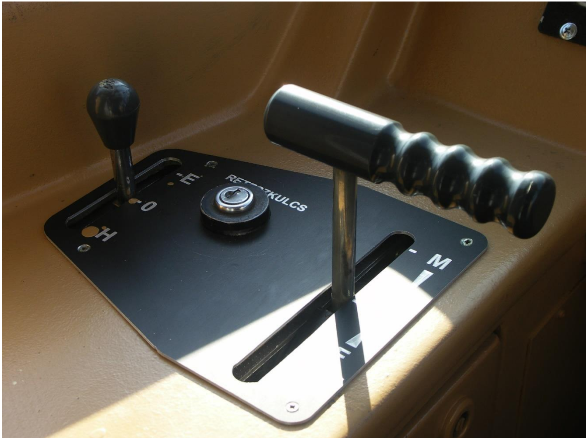
11. számú ábra: Vezérkontroller
