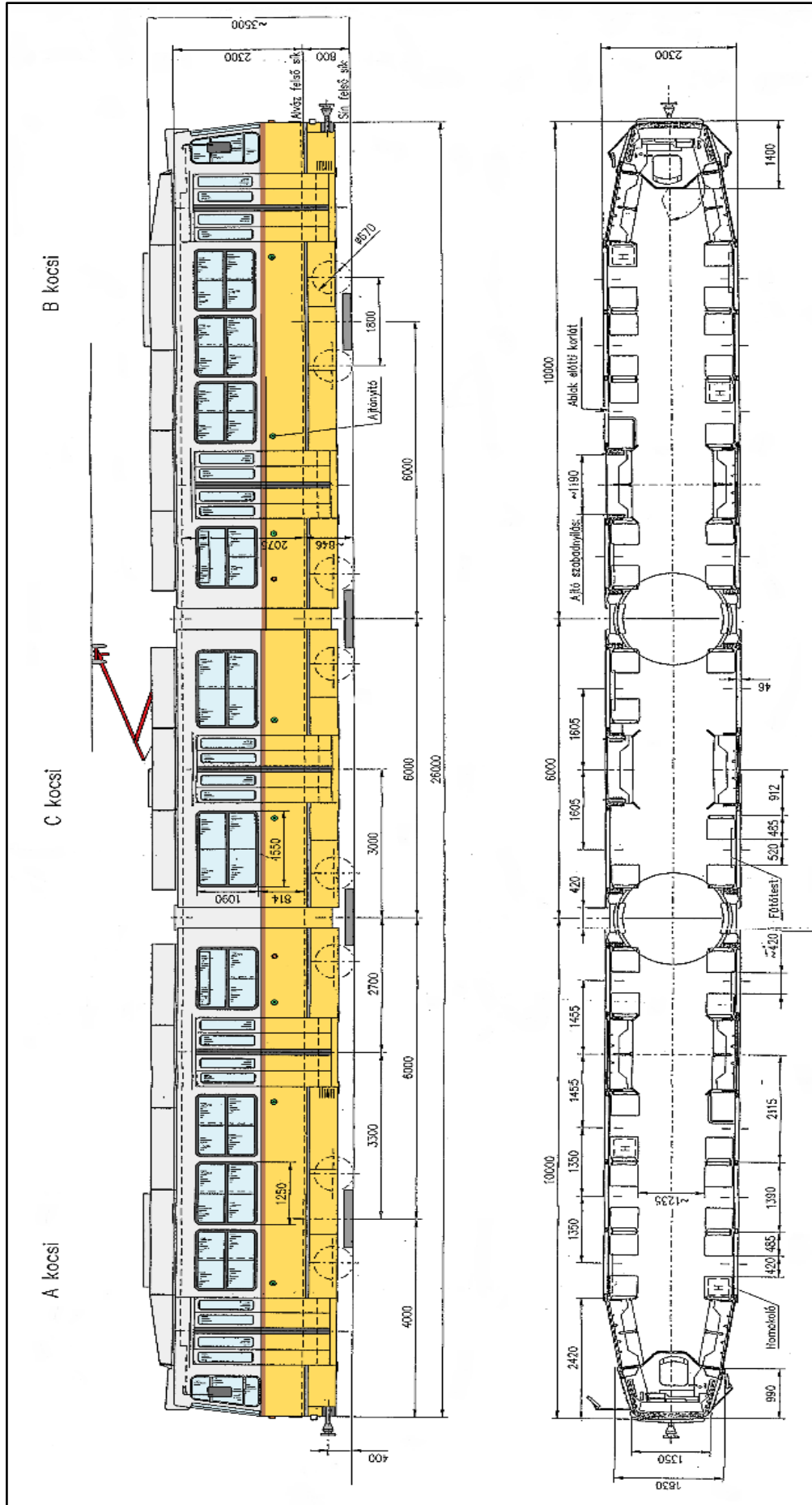
2. ábra A KCSV-7 típusú jármű méretei
