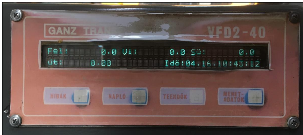
22. ábra Járműállapot kijelző a kocsí "A" végén
