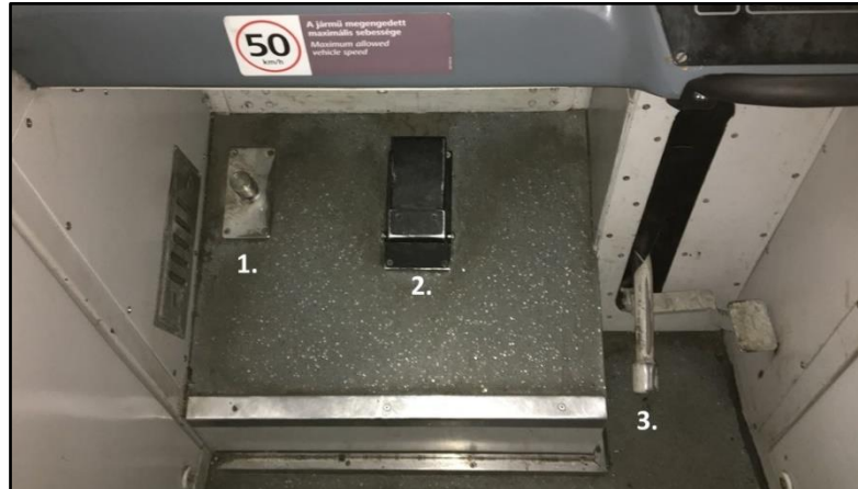
24. ábra Pályacsengő taposógomb, sínfék kapcsoló, RET kényszeroldó kar
