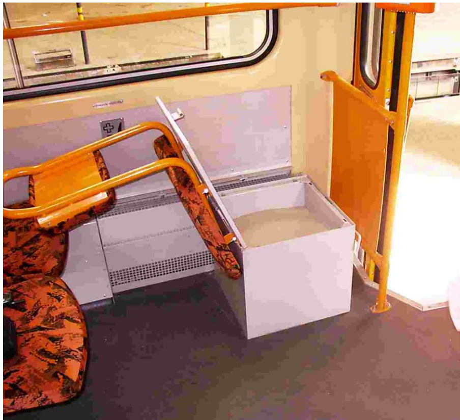
44. ábra: A feltöltött homokszóró tartály
