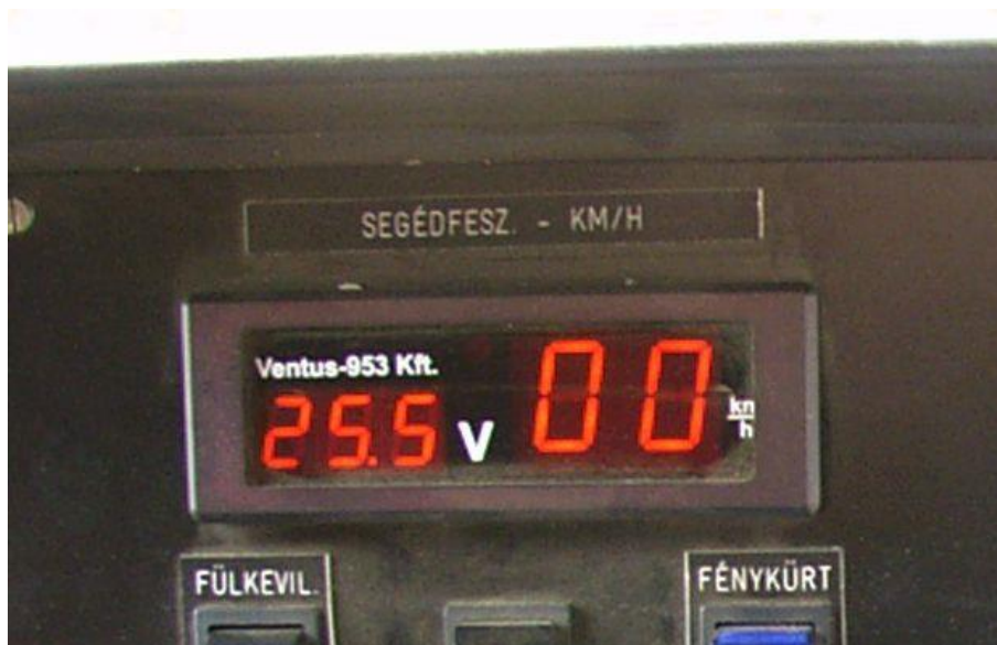
15. ábra: Feszültség- és sebességmérő műszer
