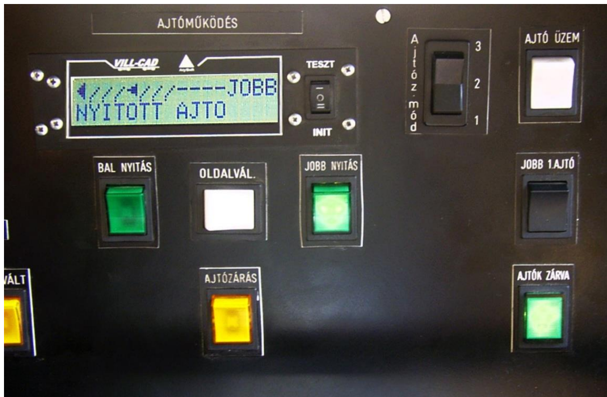
20. ábra: Az ajtóműködtetés kezelőszervei és ellenőrző berendezései
