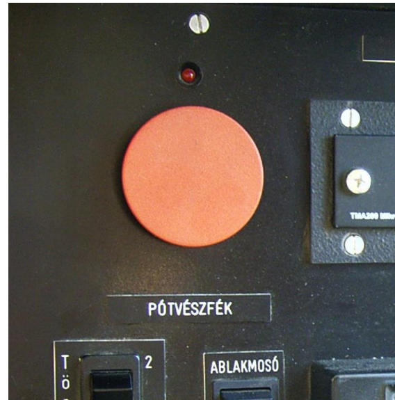
21. ábra: A pótvészfék nyomógomb és visszajelző lámpa
