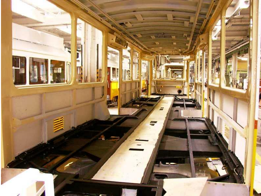
3. ábra: A kocsiszekrény szerkezeti felépítése
