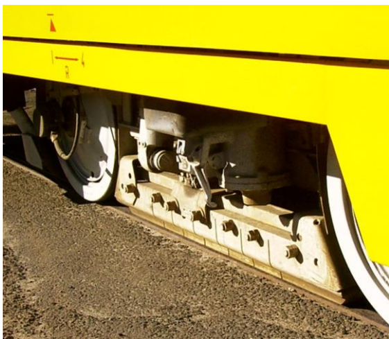
52. ábra: Az alaphelyzetben lévő rugóerőtárolós fék oldókar
