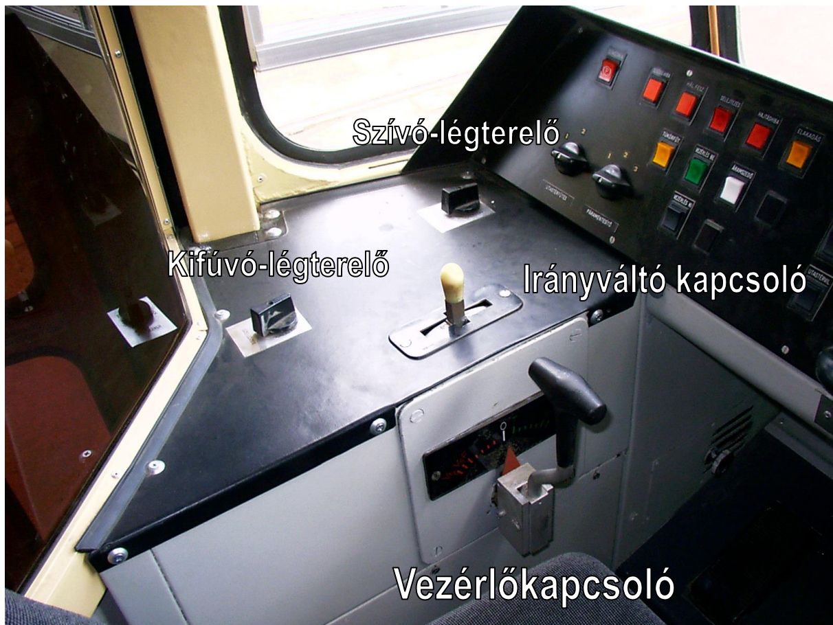
26. ábra: A vezetőfülke bal oldalán található kezelőszervek
