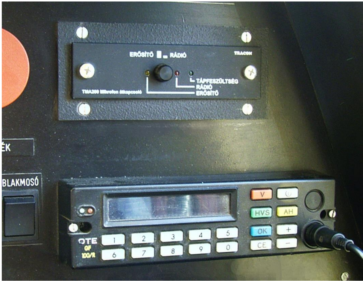
23. ábra: A forgalomirányítási- és utaskapcsolat kezelőszervei
