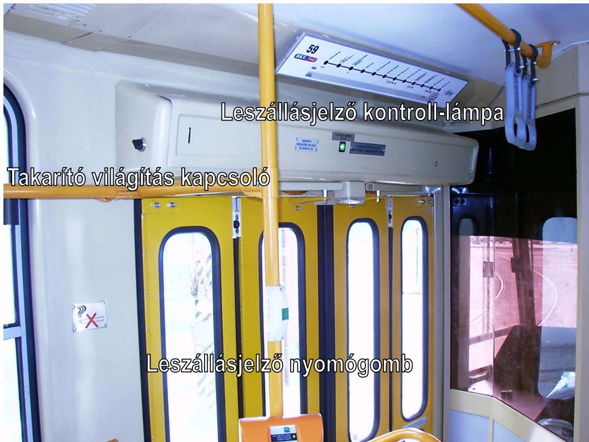
32. ábra: A leszállásjelző és a takarító világítás kapcsoló
