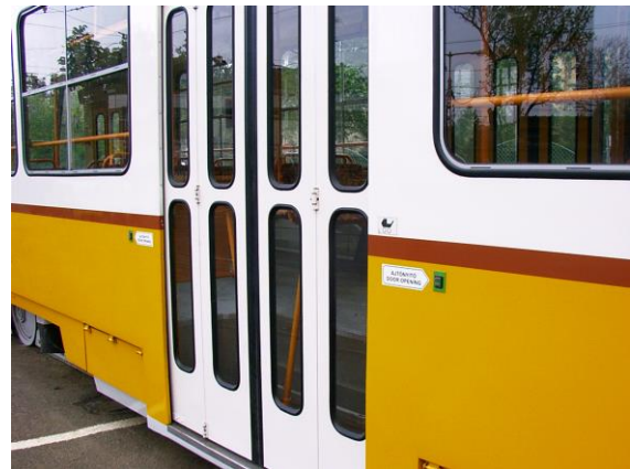
6. ábra: A járműajtók és ajtónyitó nyomógombok
