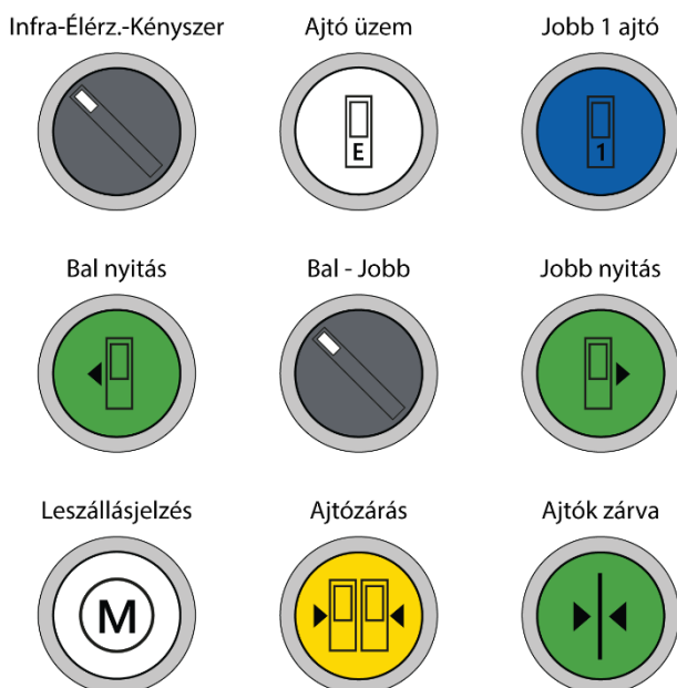
6.1. ábra: ajtóműködtető kezelőszervek a műszerpulton
