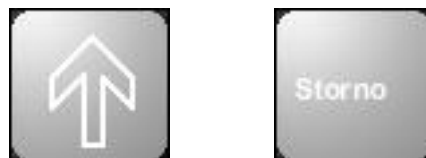
31. ábra: A megállóhely-bemondás indító és leállító nyomógombja
