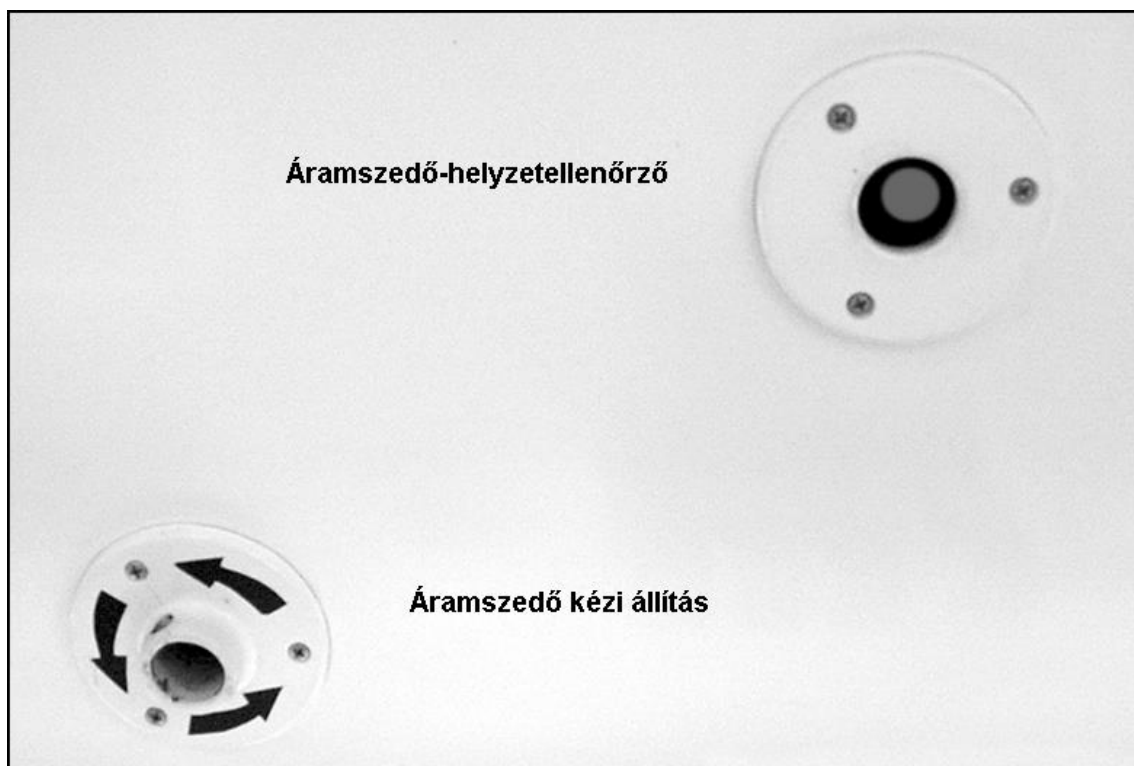
39. ábra: Az áramszedő kézi hajtókarjának csatlakozója valamint a helyzetellenőrző
