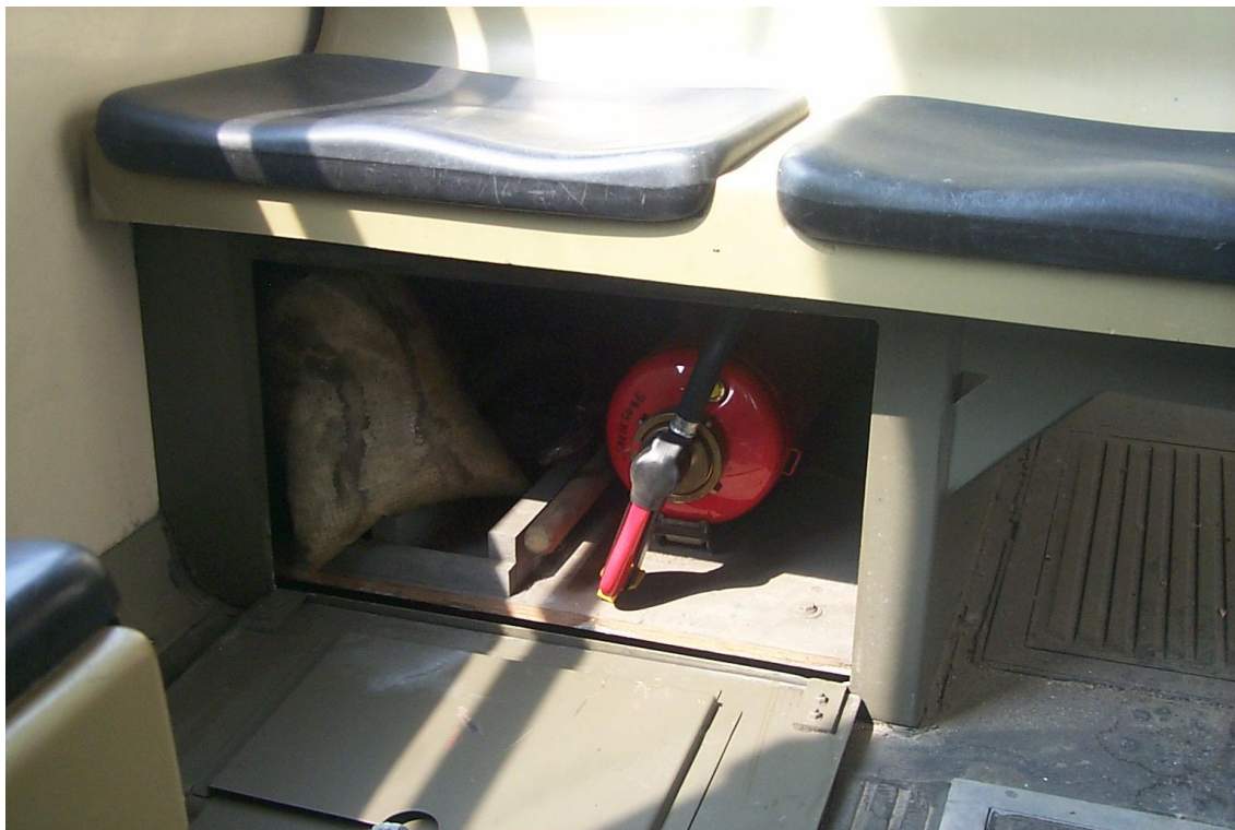
68. ábra: A tűzoltókészülék elhelyezése
