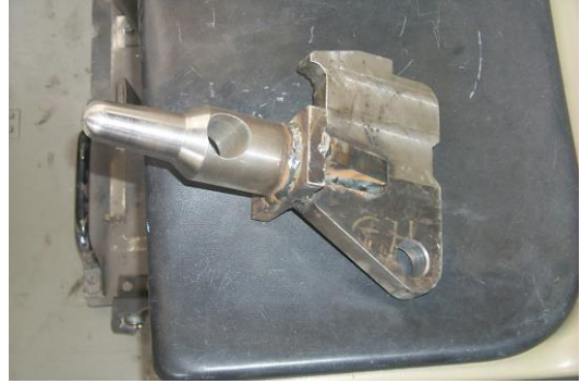
61. ábra: A T5C5 típusú jármű csatlásába helyezendő közdarab
