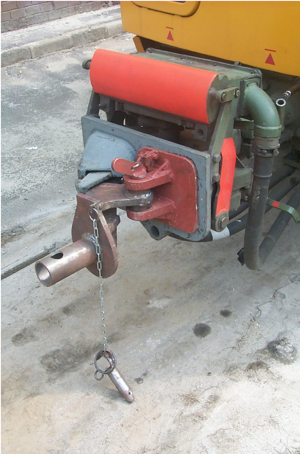
66. ábra. A T5C5 vonóelem rögzítése
