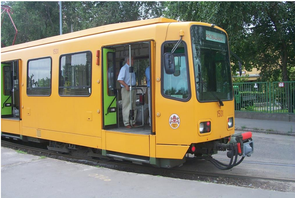
21. ábra: A lépcsők helyzete magas peron esetén
