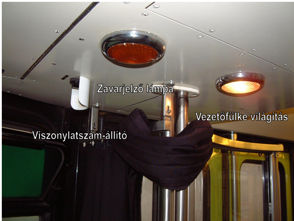
15. ábra: A zavarjelző lámpa, a vezetőfülke világítás és a viszonylatszám-állító
