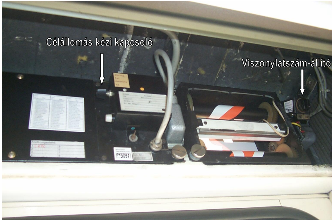
34. ábra: A célállomás-jelző és a viszonylatszám-jelző kézi kapcsolói
