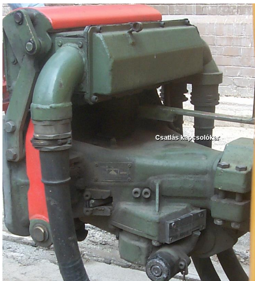
56. ábra: A csatlás kapcsolókar felhelyezése
