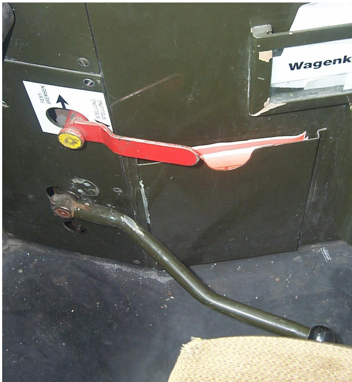
47. ábra: A rugóerőtárolós fék kézi oldókarok felhelyezése
