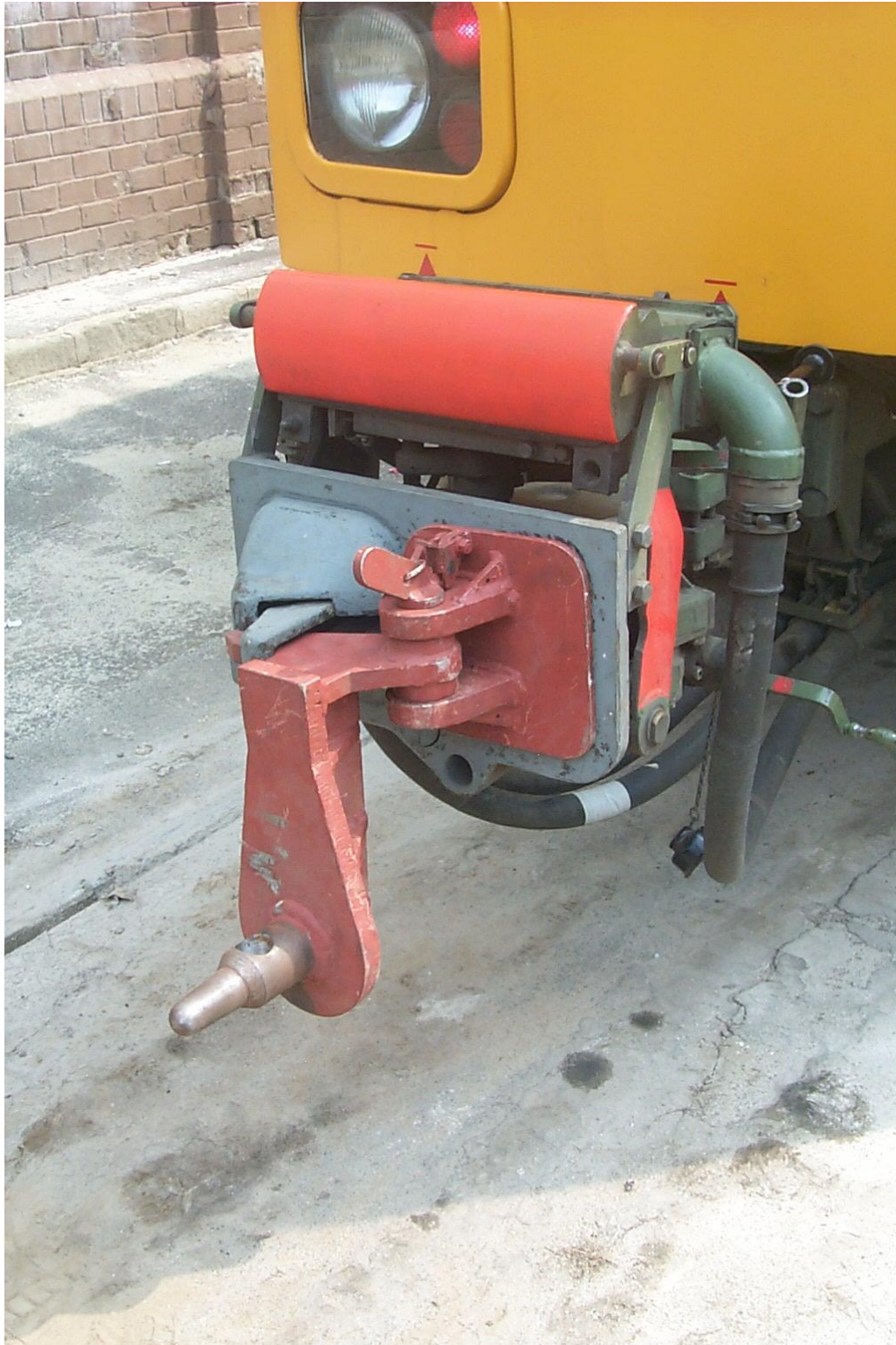
65. ábra: Az UV és Ipari csuklós vonóelem rögzítése
