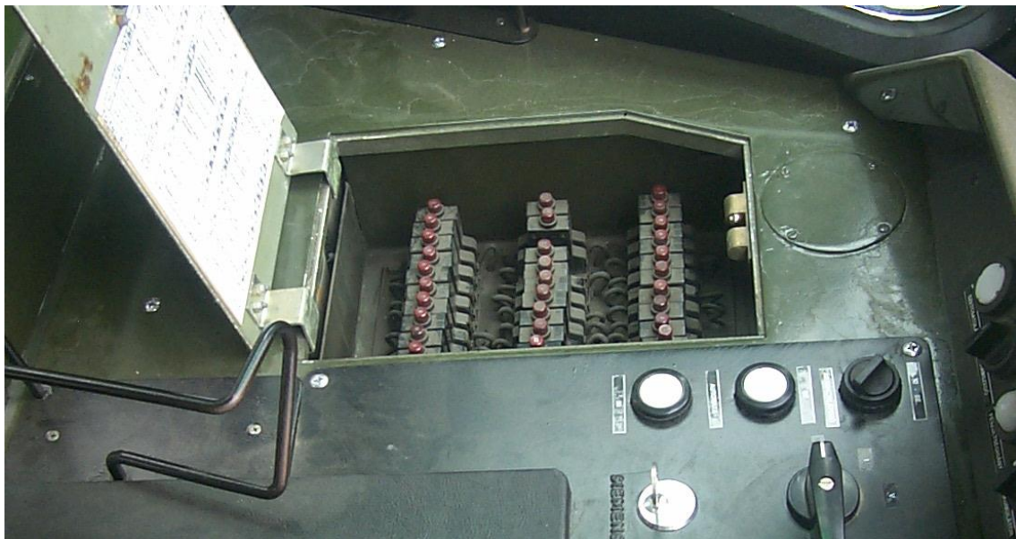
10. ábra: A vezetőfülkében található biztosítékszekrény
