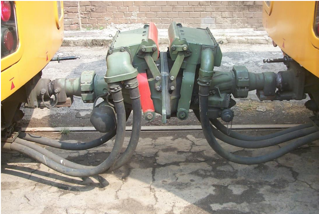
57. ábra: Csak mechanikusan csatolt kocsik
