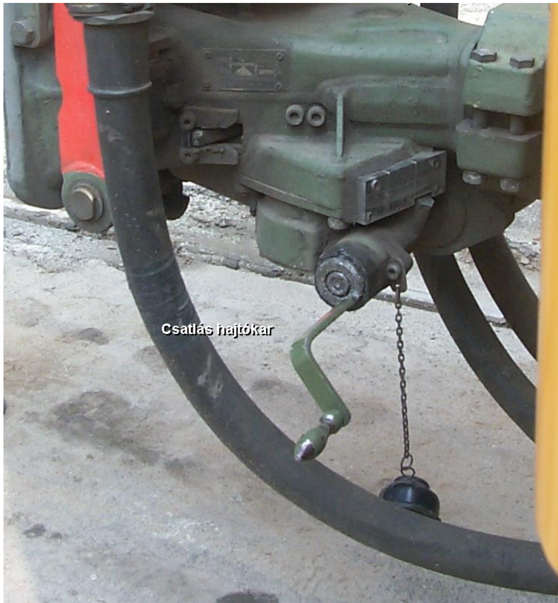
63. ábra: A csatlás hajtókar felhelyezése
